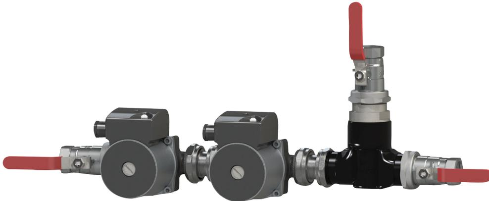
Laddomat MR 40 ist ein Ladesystem für Heizkessel mit integriertem WW-Wärmetauscher und Mischventil. Das thermische Ventil verfügt über 2 Rückschlagventile, so dass ein Durchfluss in zwei Richtungen möglich ist.
